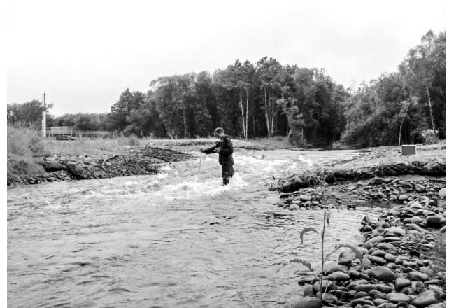
Рис. 20. Измерение скорости потока в русле одной из двух второстепенных пойменных проток р. Авачи через 4 мес. после завершения строительства ППМГ (реконструкции перехода МГ в траншее): в центре снимка – значительный искусственный перекат в створе габионов над валиками обратной засыпки, на заднем плане слева – блок-контейнер энергоснабжения кранового узла (фото 13.08.2012 г.)
