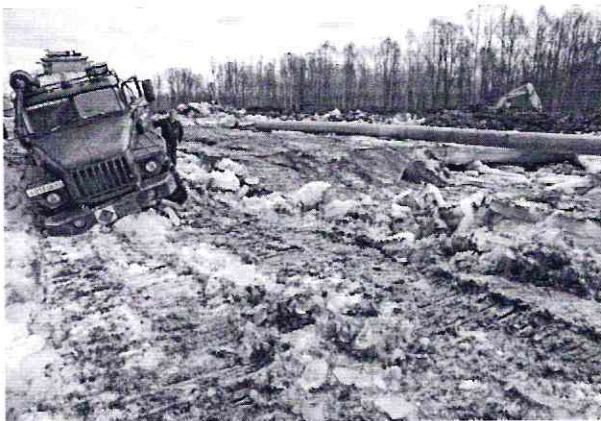
Рис. 17. Топливозаправщик, застрявший в расколотом льду разрушенной экскаватором ледовой переправы через русло второстепенной пойменной протоки в западной части долины р. Авачи (фото 27.04.2012 г.)
