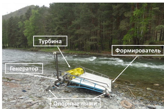
Рисунок 5. Внешний вид реальной установки на берегу реки Чемалка Республики Алтай, май 2014 года
